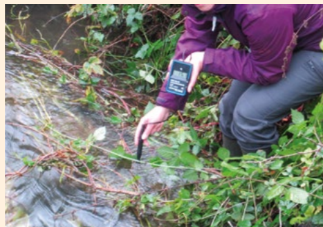
Mesure de la température de l'eau à l'aide d'un thermomètre adapté
